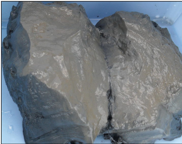
Bild 4 Ytliga sediment uttagna med Van Veen - provtagare.
