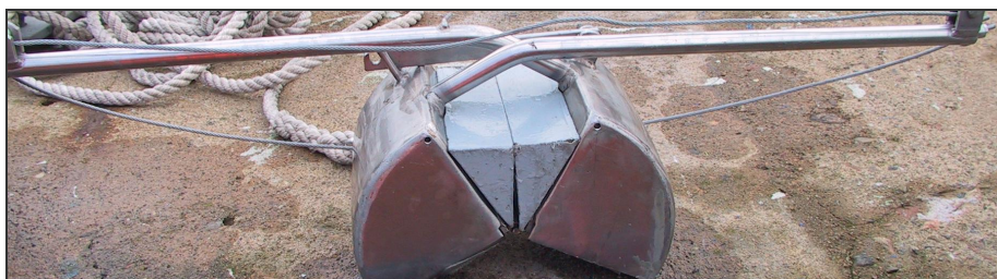
Bild 2 Van Veen - provtagare använd vid provtagningen.
