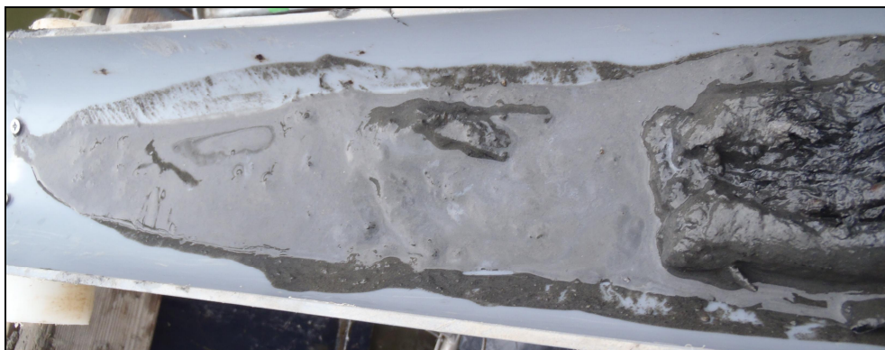
Bild 7 Oljefilm på sedimentprov och på vattenytan vid provtagning, provpunkt 16.
