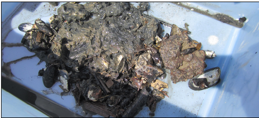
Bild 8 Betongbitar, trä och snäckskal, provtagning med bottenhuggare i provpunkt 7.
