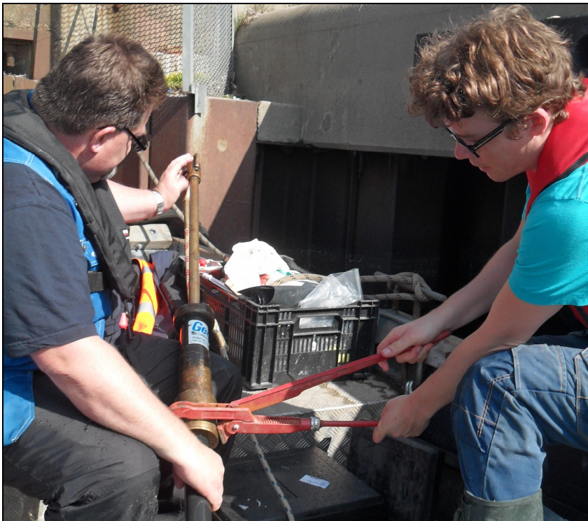
Bild 3 Kajak - provtagare använd vid provtagningen.
